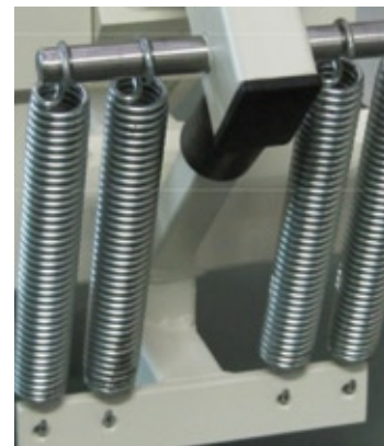
Ein Federzug erleichtert das Öffnen und Schließen der oberen Backplatte.
